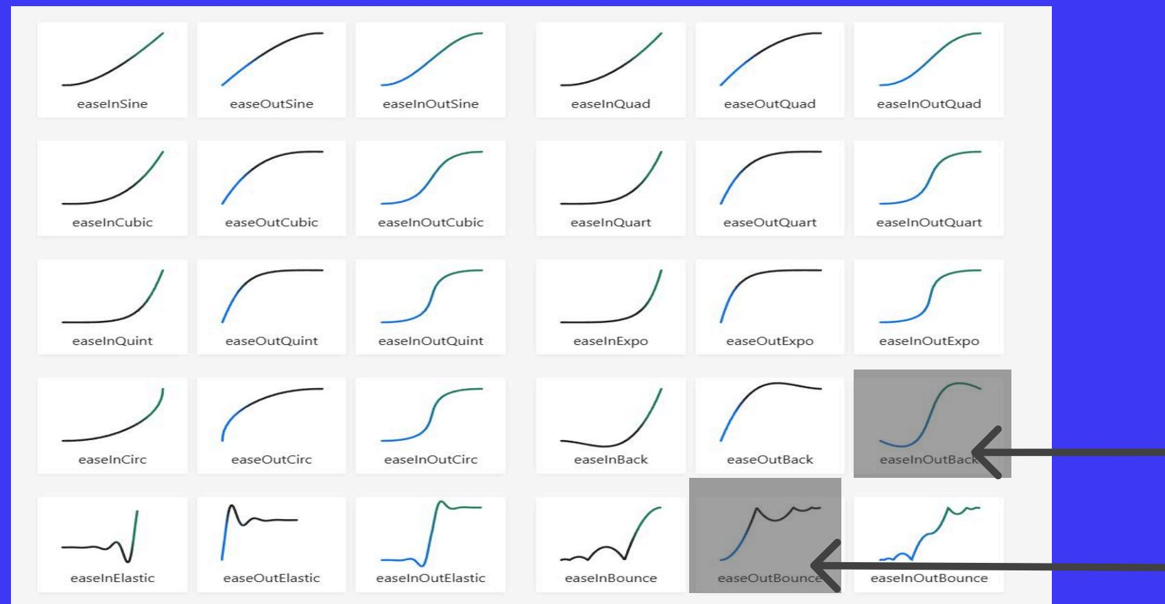
1/ Les titres **<h2>** sont initialement placés hors de la vue à **top: -400px** et se déplacent vers leur position finale **top: 15px** avec une animation fluide de **800ms**. L'animation utilise l'effet **easeOutBounce**, ce qui crée un effet de rebond à la fin du mouvement.
